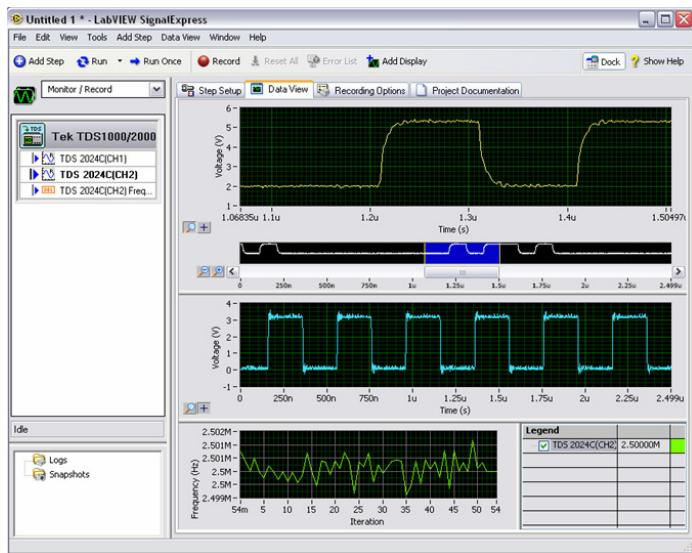
Простой захват, сохранение и анализ результатов с помощью прилагаемой базовой версии ПО LabVIEW SignalExpress от компании National Instrument.
