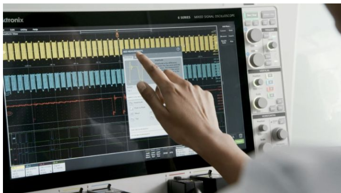
С емкостным сенсорным дисплеем можно работать так же, как с экраном смартфона или планшета.
