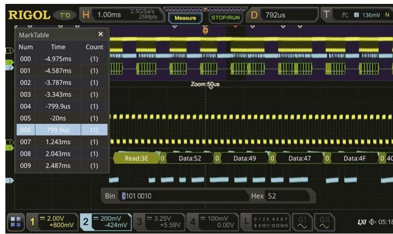
Запуск и анализ по сигналам последовательных шин встраиваемых систем SPI. Декодирование данных MISO/MOSI (4-32 бита) шины SPI. Доступный режим включает «Тайм-аут» и «CS»:
